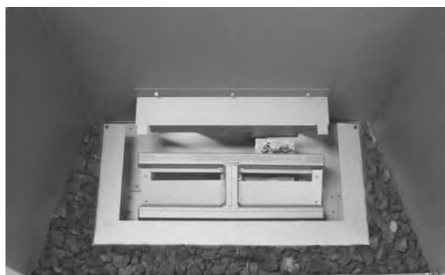
Étape 4 : replissez la plateforme pour roche avec les pierres de lave. Ne pas placer de pierres sur le tube du brûleur.
