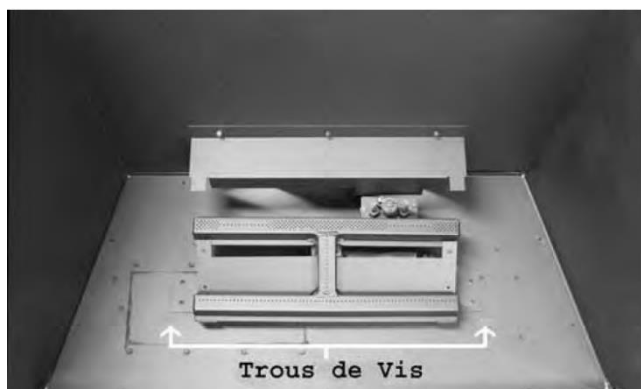
Étape 2 : remplacez/réinstallez les 2 vis du barreau de grille.
